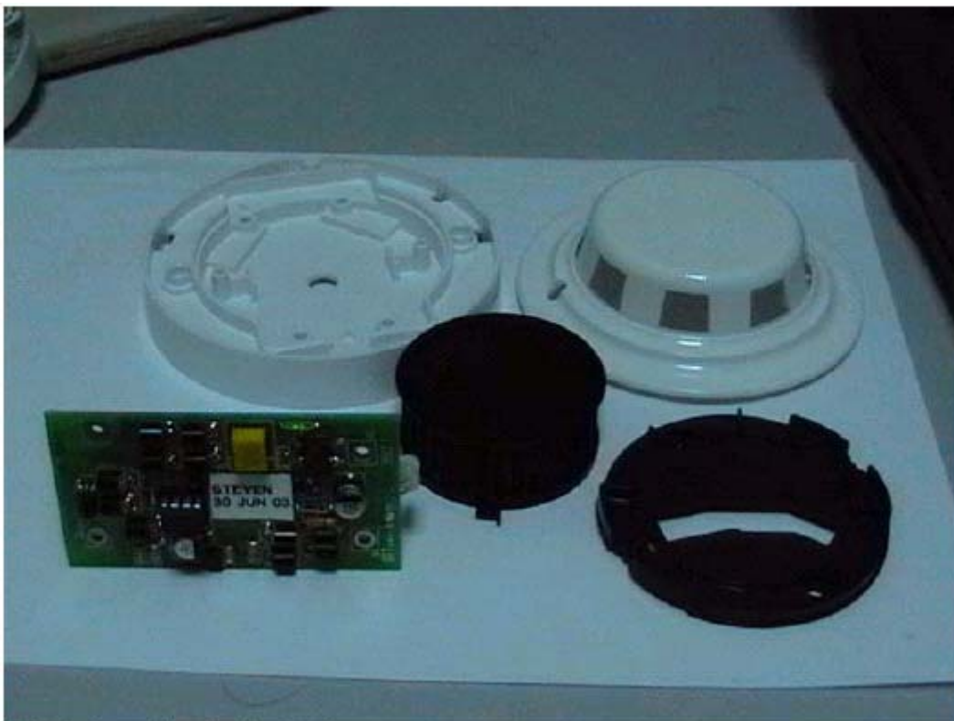
Partes constitutivas del detector de humo.
