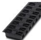
Carcasa base placa de circuito impreso, corriente nominal: 12 A, tensión de dimensionamiento (III/2): 320 V, número de polos: 9, paso: 5,08 mm, color: negro, superficie contactos: Estaño, montaje: Soldar THR, Encontrará más información para el usuario y recomendaciones de diseño sobre la tecnología Through Hole Reflow en 'Downloads'
