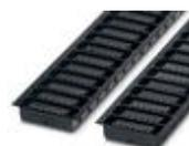
Carcasa base placa de circuito impreso, corriente nominal: 12 A, tensión de dimensionamiento (III/2): 320 V, número de polos: 9, paso: 5,08 mm, tipo de conexión: Conexión enchufable, color: negro, superficie contactos: Estaño, montaje: Soldar THR, Conectores macho "Two In One" siempre deben componerse de un segmento izquierdo (L) y uno derecho (R). Téngase en cuenta la pieza opuesta correspondiente bajo "Accesorios" para completar el conector macho THR.
