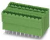
Carcasa base placa de circuito impreso, corriente nominal: 10 A, tensión de dimensionamiento (III/2): 320 V, número de polos: 9, paso: 5,08 mm, color: verde, superficie contactos: Estaño, montaje: Soldadura por ola, En el caso de una combinación con partes enchufables MVSTB o FKCV, debe utilizarse un conector MVSTBW (o FKCVW) y un conector MVSTBR (o FKCVR), respectivamente. ¡Una combinación con partes enchufables TMSTBP no es posible!
