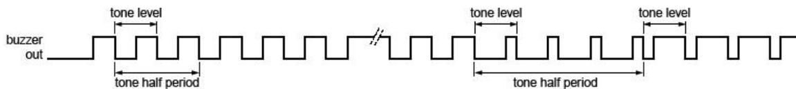
Figure 27. BUZZER Output
